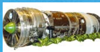
我国自行研制的第一台大推力涡轮风扇发动机“太行”发动机
